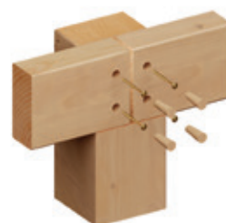
Schroefverbindingen met houten doken
